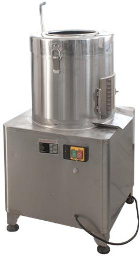
Длительность цикла очистки - 2 мин. Вместимость - 8 кг. Картофелечистка оснащена регулируемыми по высоте ножками. Производительность 240 кг/ч частота вращения рабочего Вала 1400 об/ мин.
