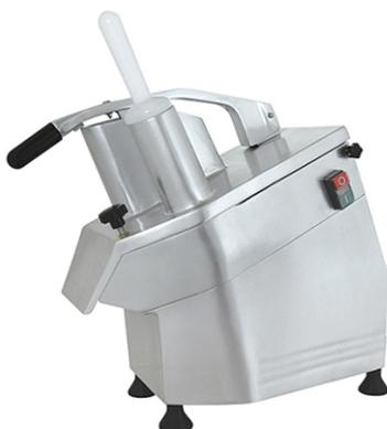
Установка: настольная. Тип загрузки: ручная. Режим работы: повторно-кратковременный. Максимальная длительность рабочего цикла 10 мин. Скорость вращения 270 об/мин. Производительность 300 кг/час. Материал овощерезки: алюминий и магниевый сплав. В комплект входит набор из 5 дисковых ножей: ломтики 2 и 4 мм, терка 3, 4 и 7 мм. Ножи выполнены из нержавеющей стали. Диаметр каждого ножа: 205 мм. Материал крепежной пластины/диска: пластик.
