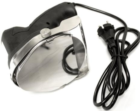
Нож для шаурмы применяется на предприятиях общественного питания и торговли. Модель оснащена регулировочным винтом для регулировки толщины резки, ножевым предохранителем и шнуром питания с защитным кожухом. Корпус выполнен из пластмассы. В комплект поставки входит дополнительное лезвие.
